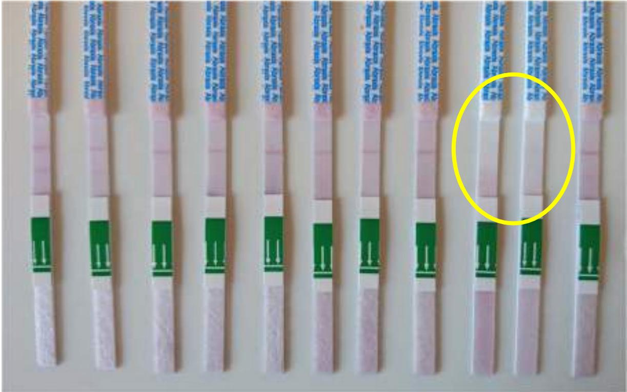
*Fig. C17- Autre exemple de bandelettes défaillantes (essai "eaux brutes"). Noter la différence de coloration des zones test et zones tampons sur les bandelettes de droite: la première a absorbé sur 1/3, la seconde n'a rien absorbé.*
